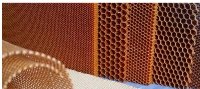
а – пенопласт, б-поропласт, в - сотопласты Рисунок 5.9 - Тепло – и – звукоизоляционные материалы
