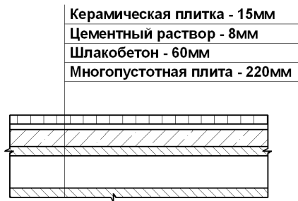
Рис. 2.2. Конструкция панели перекрытия
