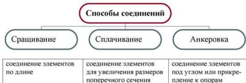
Рисунок 10.2 – Способы соединений деревянных элементов.
