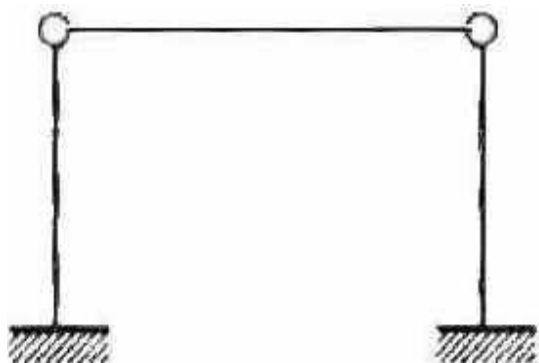
Рисунок 6.2– Двухшарнирная жестко опертая статически неопределимая рама
