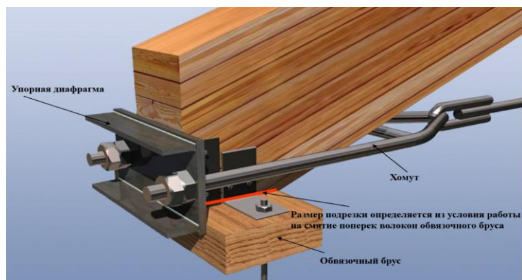
Рисунок 6.10 – Опорный узел треугольной фермы
