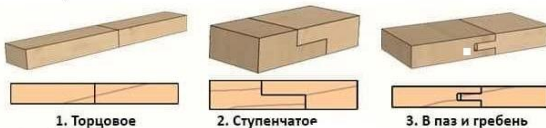
1 – торцовое, 2 – ступенчатое, 3 – в паз и гребень.
