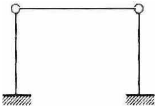
Рисунок 7.2– Двухшарнирная жестко опертая статически неопределимая рама
