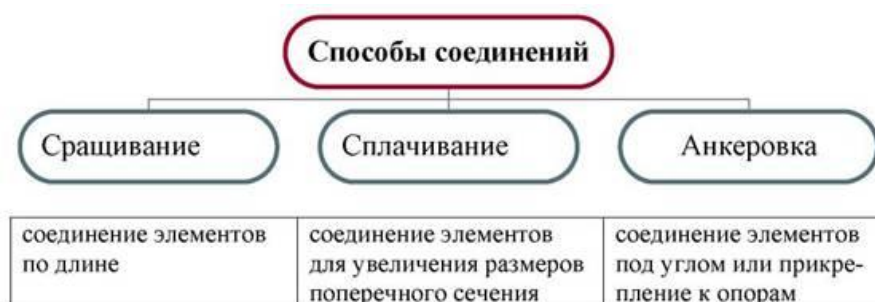
Рисунок 1.2 – Способы соединений деревянных элементов
