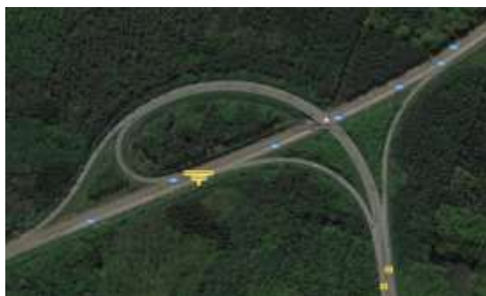
Рисунок 20 - План транспортной развязки «левая труба» с полупрямым огибающим ЛПО на примыкании дорог
