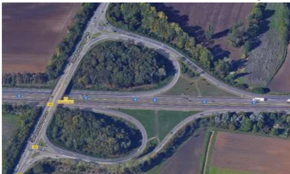
Рисунок 29 - Кольцевой диагональный «неполный клеверный лист»
