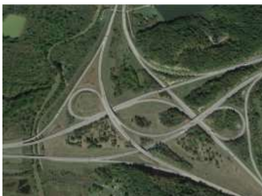
Рисунок 18 - Транспортная развязка «раздвинутый клеверный лист» с улучшенными прямыми левоповоротными соединительными ответвлениями
