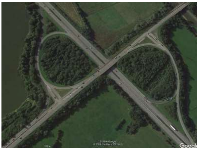
Рисунок 31 - Накопительный диагональный «неполный клеверный лист»
