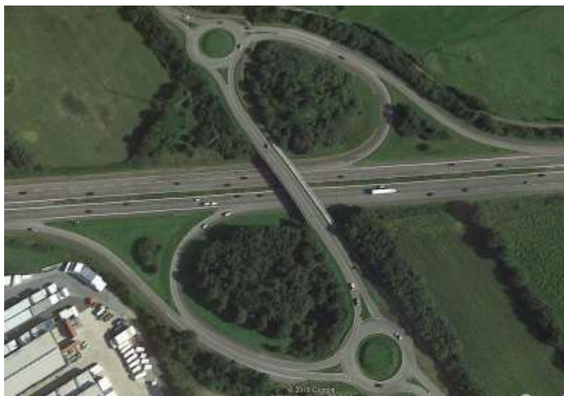
Рисунок 29 - Кольцевой диагональный «неполный клеверный лист»
