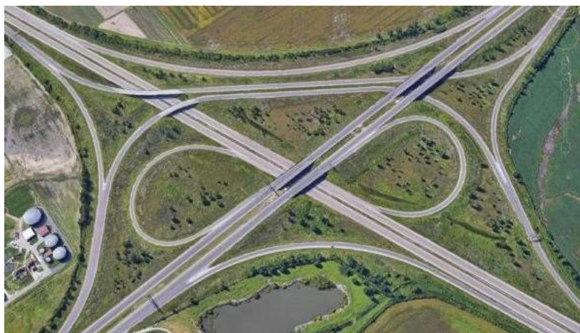
Рисунок 16 - Улучшенная транспортная развязка «клеверный лист» с заменой двух петлеобразных ЛПО на полупрямые огибающее и направленное
