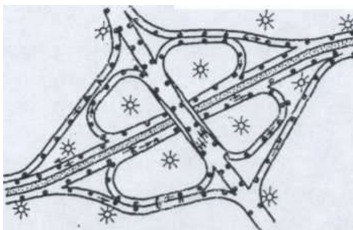
Рисунок 2 -Схема размещения светильников на пересечении дорог по типу клеверного листа
