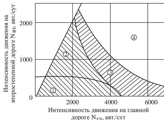
1 – простое пересечение; 2 – направляющие островки на второстепенной дороге; 3 – направляющие островки на обеих дорогах с разметкой проезжей части; 4 – пересечение в разных уровнях
