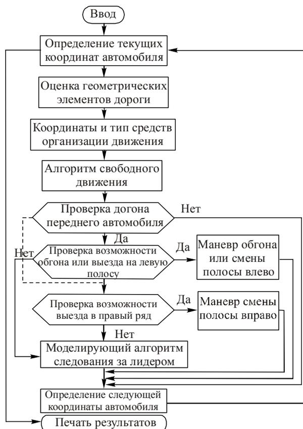
Рисунок А.1 – Общий моделирующий алгоритм движения потока автомобилей (смена полосы влево или вправо предусматривается только для многополосных дорог)
